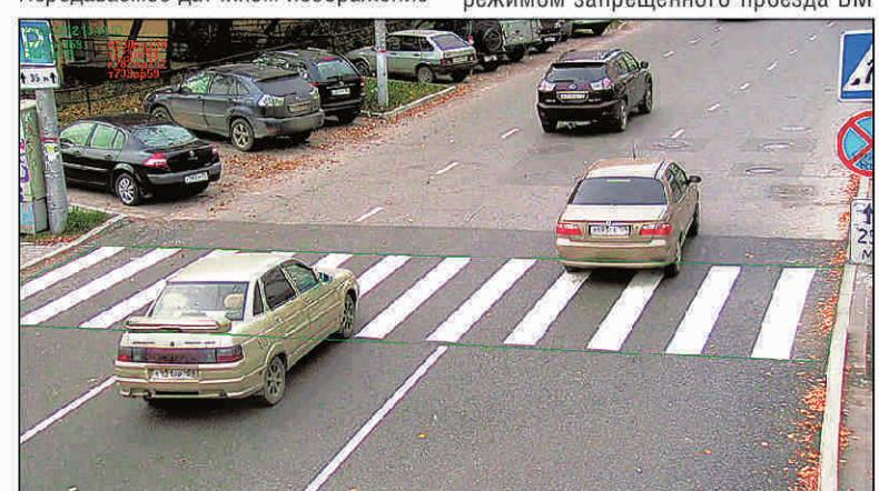
распознает его ГРЗ, определяет вектор движения и сопоставляет с вектором движения пешехода. В случае если эти векторы пересекаются и при этом вектор движения пешехода изменился, т.е. пешеход либо изменил скорость, либо направление движения, — это означает, что была создана помеха его движению. ВМ формирует материал о нарушении ПДД. В случае если векторы не пересеклись — ТС продолжил движение за спиной пешехода, — материал о нарушении не формируется.
